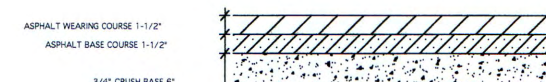
TYPICAL STREET PAVEMENT SECTION (N.T.S.)
