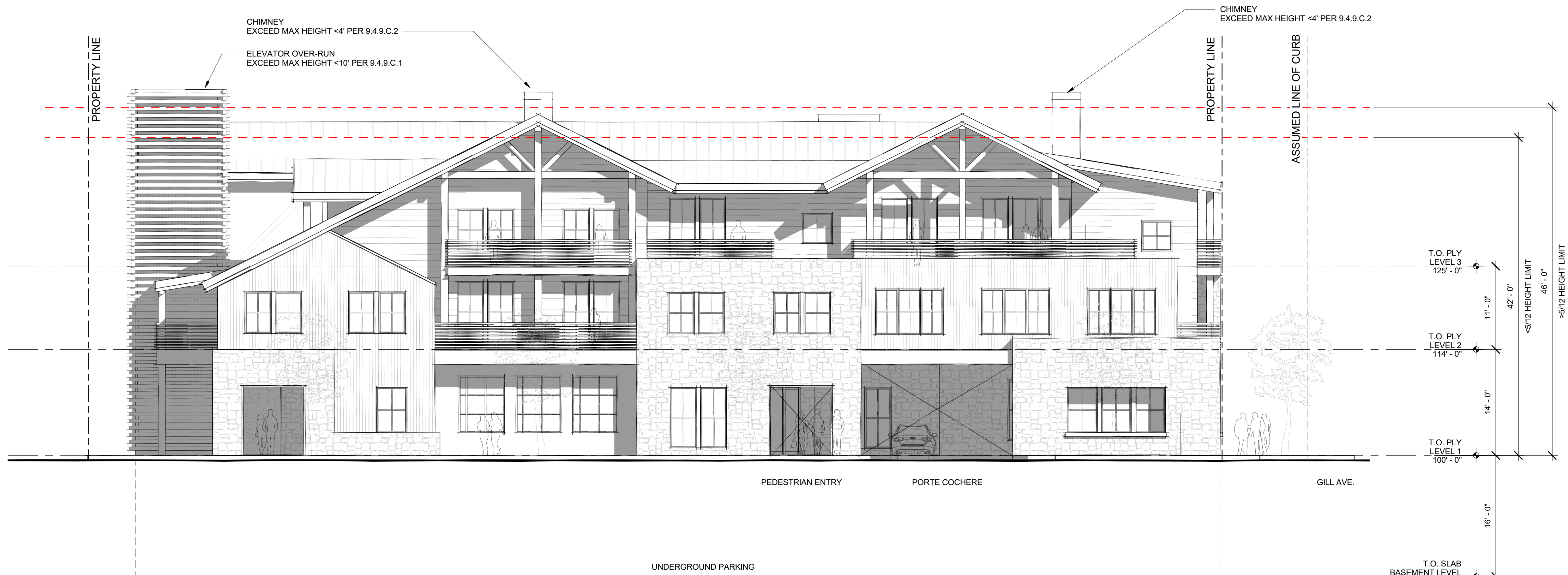
1 A4.1 EAST ELEVATION - N. JACKSON STREET SCALE: 1/8" = 1'-0"
